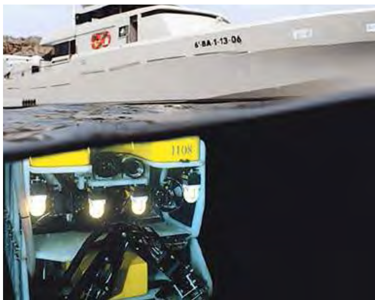
ROBOT. El 'Bon Pigall' té un vehicle submarí que pot baixar fins a 2.000 metres
