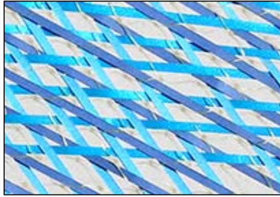
Figura 5. Detalle del entrelazado de las cintas.
