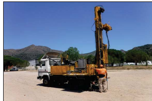
Foto 11: Ensayo DPSH P-1.
