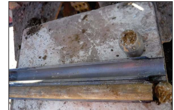
Foto 4: Sondeo S-1, SPT a 5,5 metros.
