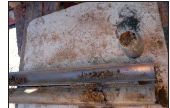
Foto 2: Sondeo S-1, SPT a 1,0 metro.
