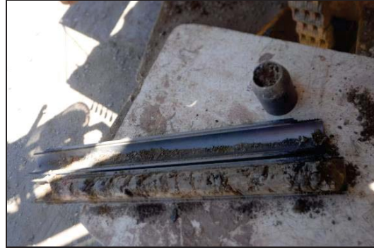
Foto 19: Sondeo SC-3, SPT a 1,0 metro.
