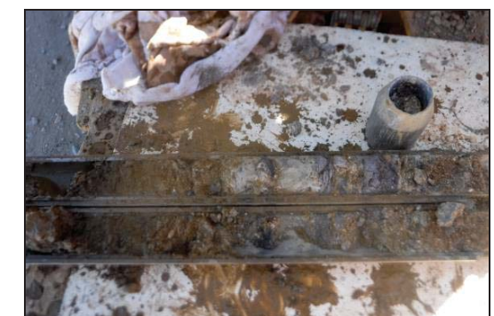
Foto 6: Sondeo S-2, SPT a 1,8 metros.
