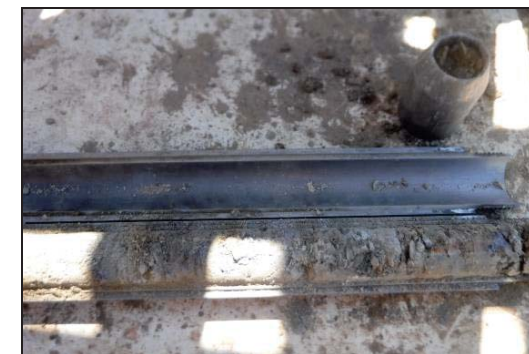
Foto 17: Sondéo SC-2, SPT a 1,5 metros.
