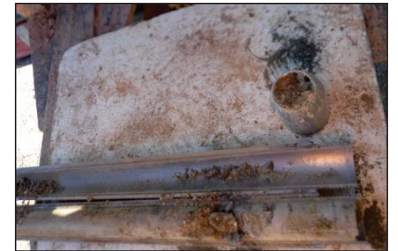
Foto 2: Sondeo S-1, SPT a 1,0 metro.
