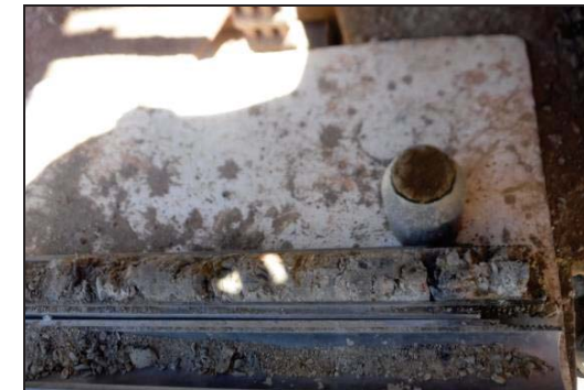
Foto 15: Sondéo SC-1, SPT a 0,9 metros.
