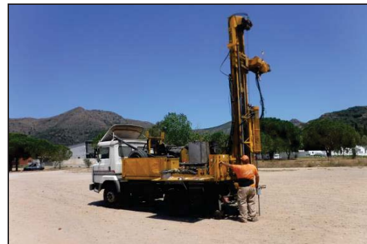
Foto 11: Ensayo DPSH P-1.
