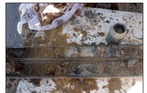
Foto 6: Sondeo S-2, SPT a 1,8 metros.
