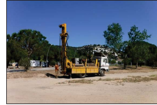
Foto 13: Ensayo DPSH P-3.
