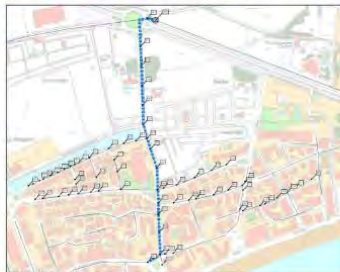
Figura 86: Trams sense inspecció amb càmera CCTV a la zona B. Barri Santa Margarida i Barri El Salatar
