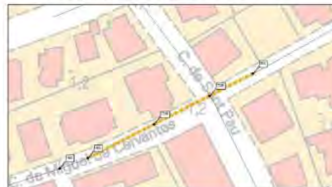
Figura 74. Actuació 2.8, Reposició dels col·lectors amb mànega
