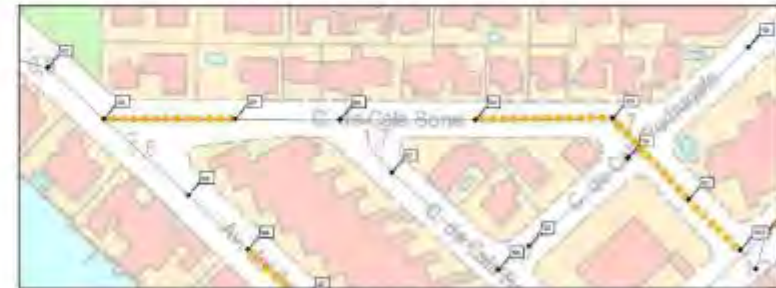
Figura 44: Actuació 2.2. Reposició dels col·lectors amb mànega entre els pous de registre 802 - 824
