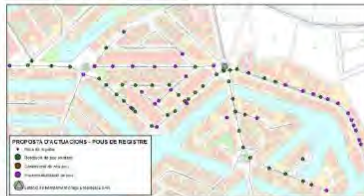
Figura 79: Actuacions per a la reposició i impermeabilització de pous de registre
