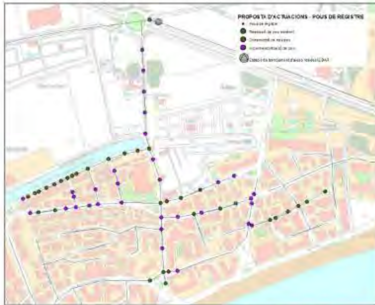
Figura 80: Actuacions per a la reposició i impermeabilització de pous de registre
