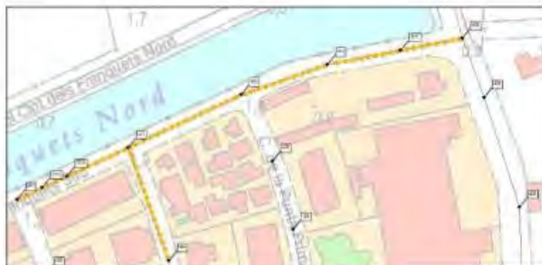
Figura 67. Actuació 2.6. Reposició dels col·lectors amb mànega
