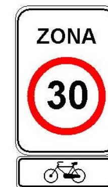
Figura 23. Senyal vertical en un carrer amb itinerari bici on hi ha coexistència bicis - vehicles motoritzats
