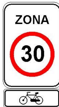
Figura 26. Senyal vertical en un carrer amb itinerari bici on hi ha coexistència bicis - vehicles motoritzats
