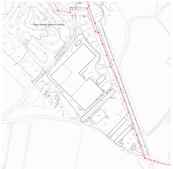
Xarxa de sanejament d'aigües residuals
