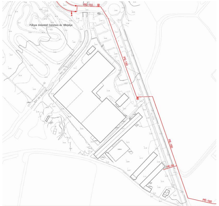
Xarxa d'aigua existent
