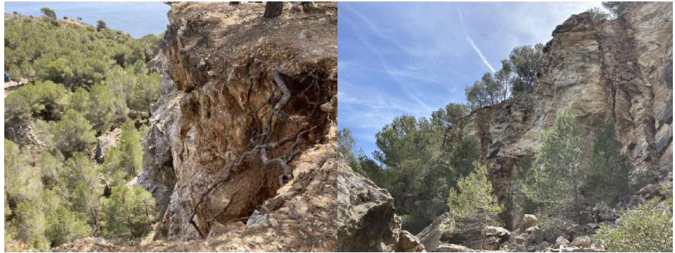
Fotografies 2: Materials argilosos i sauló a l'indret després. Aspecte de la presència vertical de les cavitats càrstiques al llarg del front d'explotació de la pedrera.
