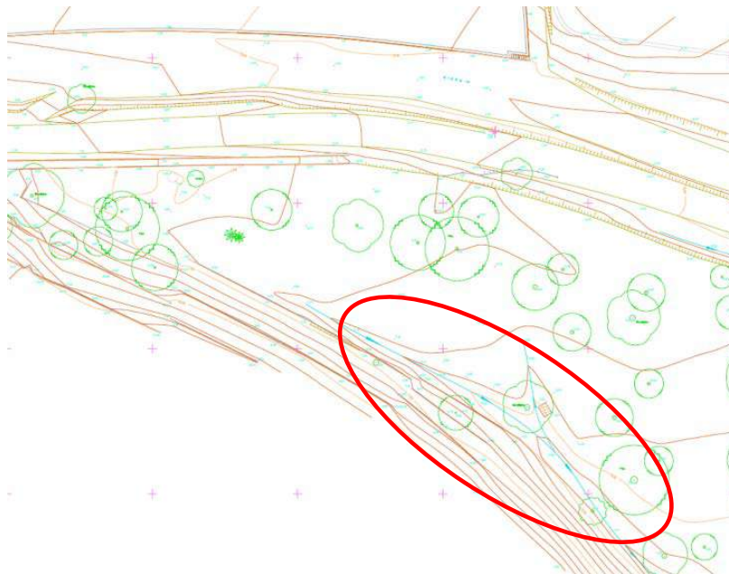
Imatge 35. Topogràfic detall on s'observa l'escòrrec
